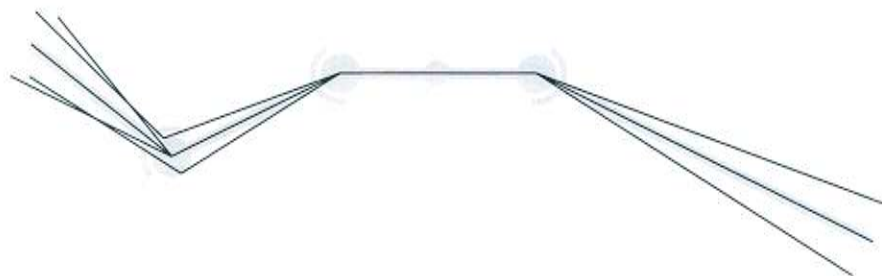
Abbildung 3.8: Prädiktion von \hat{\mathbf{x}}[k+1|k] und \mathbf{P}[k+1|k] . Die Ungenauigkeit \mathbf{P}[k|k] der letzten Zustandsschätzung \hat{\mathbf{x}}[k|k] ist durch die gestrichelten Linien angedeutet. Sie vergrößert sich (gepunktete Linien) bei der Prädiktion um das Systemrauschen \mathbf{Q} .
