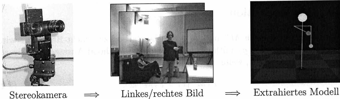
Abbildung 2.1: Eine Stereokamera liefert kontinuierlich Bildpaare, aus denen die Positionen von Kopf und Händen extrahiert werden.
