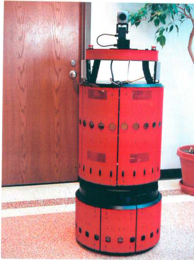
Abbildung 2.3: LEWIS ( http://www.cse.wustl.edu/MediaAndMachines/Lewis/ ) ist ein mobiler Roboter, dessen Aufgabe es ist Personen zu fotografieren.
