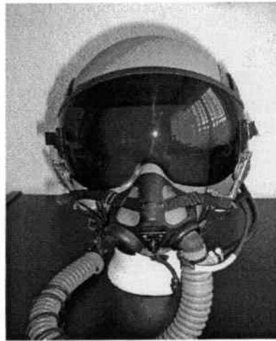
Abbildung 2.1: Helm und Sauerstoffmaske eines Jetpiloten
