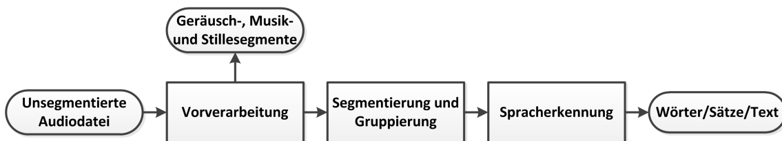
Abbildung 3.1: Überblick über die am Prozess der Spracherkennung beteiligten Systeme
