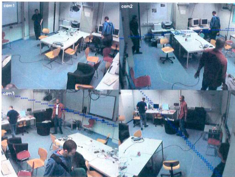
Abbildung 13: Als blaue Punkte eingezeichnete LoVs in CAM2 bis CAM4 für den Mittelpunkt der schwarz gekleideten Person aus CAM1
