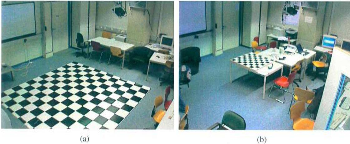
Abbildung 1.1: Ein großer Kalibrierungsteppich (a) mit einer Größe von  $3\text{m} \times 3\text{m}$  und ein kleineres Kalibrierungsschachbrett (b) mit einer Größe von  $84\text{cm} \times 84\text{cm}$ .
