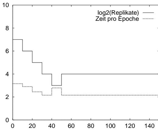
Abbildung 11.13: Ausschnittvergrößerung aus Abbildung 11.12 für die Epochen 0 bis 150. Dies ist der Einschwingvorgang der Replikatanzahlwahl.
