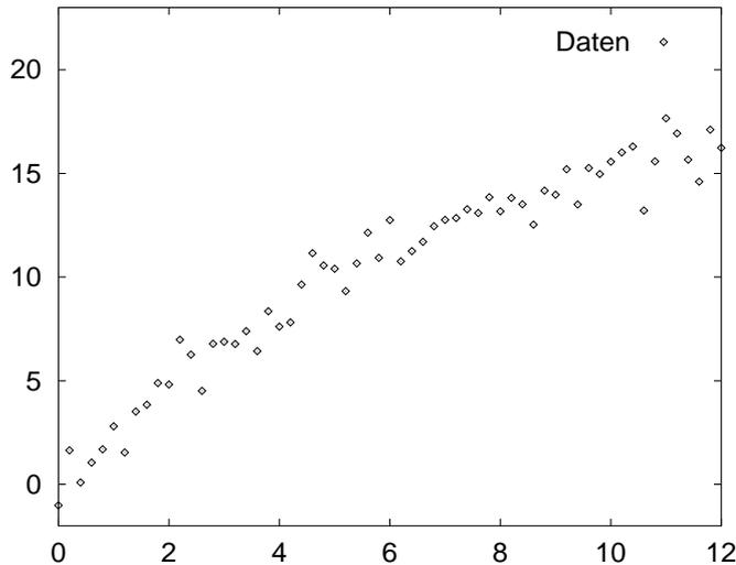
Abbildung 2.2: Punkte des Beispieldatensatzes. Die Daten sind nicht, wie man meinen könnte, mit einer verrauschten linearen Funktion erzeugt, sondern aus der Überlagerung von  $2,5x + 0,1x^2$  mit standardnormalverteiltem Rauschen.
