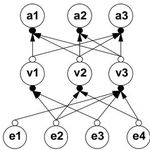
Abbildung 10.2: Beispielnetz: Vorwärtsgerichtetes 4:3:3 Netz mit Eingangsschicht e, verborgener Schicht v und Ausgangsschicht a. Die Verbindungsstruktur ist unregelmäßig. Jede Schicht entspricht einer Knotengruppe. Die kleinen Kreise symbolisieren Schnittstellen. Die Verbindungsobjekte werden wir später bei den ungefüllten Kreisen allozieren.
