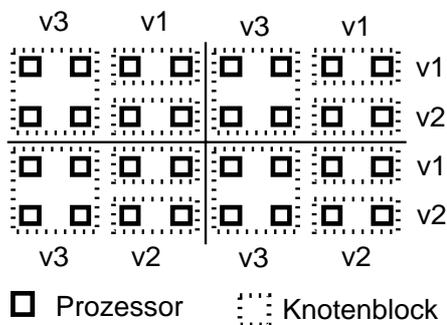
Abbildung 10.3: Knotendatenreplikation, knotenlastproportionale Prozessorzuweisung und Netzreplikation für verborgene Schicht (Knoten v1, v2, v3) des Beispielnetzes auf 2-D Prozessorfeld von 8 mal 4 Prozessoren, wenn 4 Netzreplikate verwendet werden. Netzreplikatgrenzen sind durch die durchgezogenen geraden Linien angedeutet.
