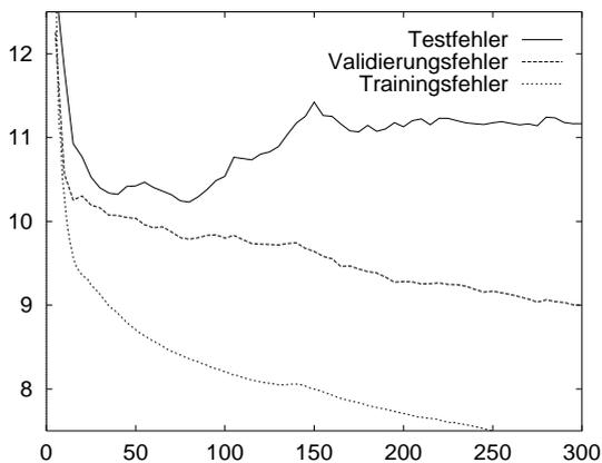
Abbildung 4.3: Beispiel für eine irreführende Schätzung des Generalisierungsfehlers. Das scheinbare Sinken des Generalisierungsfehlers, geschätzt durch den Validierungsfehler (mittlere Kurve), findet im später zur Beurteilung des Netzes benutzten Testfehler (obere Kurve) keinen Niederschlag (Trainingsepochen in  $x$ -Richtung, Fehler in  $y$ -Richtung, Datensatz `glass1`, Netz mit  $8+8$  verborgenen Knoten und allen Direktverbindungen).
