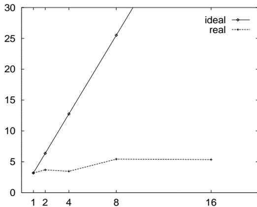
Abbildung 11.8: Ideales und reales Skalierungsverhalten von autopruno mit Pivot-Architektur für glass1 zwischen 1k und 16k Prozessoren ( $x$ -Achse), gemessen in Epochs pro Sekunde ( $y$ -Achse).
