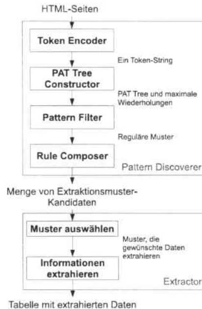
Abbildung 4.1: Flussdiagramm des Pattern Discoverers und Extractors
