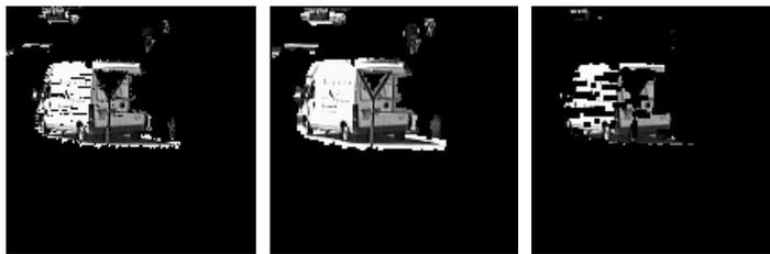
**Abbildung A.4:** Dilatation und Erosion mit einer  $3 \times 3$  Maske. Links: das Originalbild. Mitte: Ergebnis der Dilatation. Rechts: Ergebnis der Erosion.
