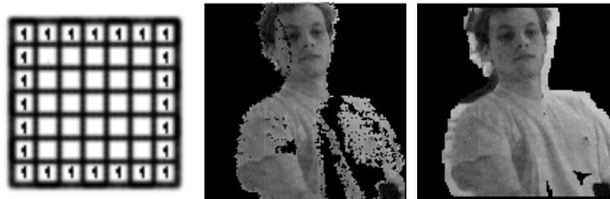
**Abbildung 3.3:** Dilatation mit einem Strukturelement. Links: das Strukturelement. Mitte: das Originalbild. Rechts: Ergebnis der speziellen Dilatation
