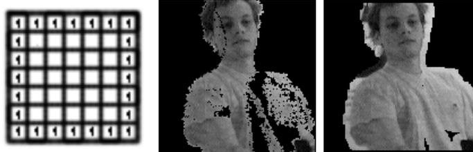
**Abbildung A.6:** Dilatation mit einem Strukturelement. Links: das Strukturelement. Mitte: das Originalbild. Rechts: Ergebnis der speziellen Dilatation
